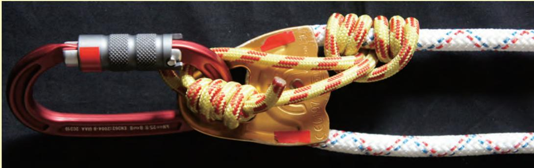
スウィングスライドプーリーのなかでも滑車に隣接するプレートのエッジが角ばっていてブルージックを押し下げる効果をもつブルージックマインドプーリーはブルージックコードと併用してプーリーカムを構築できる。
