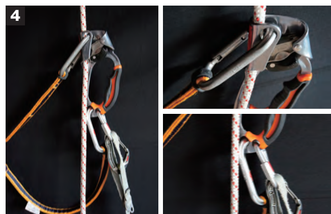
④ハンドアッセンダーのトップホールにショートカウズテイルを、ボトムホールにロングカウズテイルを接続し、2点確保とする。
