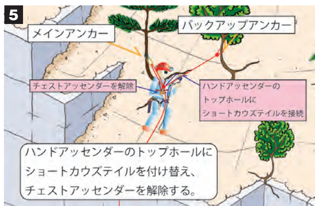
⑤ハンドアッセンダーを付け替えて2点確保ができていることを確認後、チェストアッセンダーを解除する。
