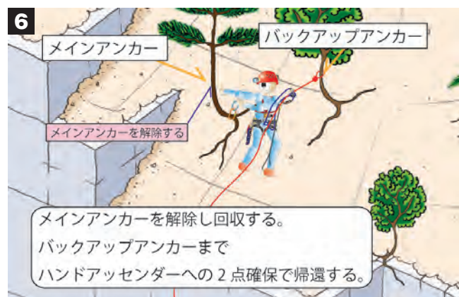
⑥ピッチヘッドアンカー（メインアンカー）を撤収し、最初のアンカー（バックアップアンカー）までハンドアッセンダーでの2点確保で帰還する。メインアンカーを解除しているため、ロープに体重をのせてはならない。
