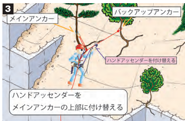
③ハンドアッセンダーをメインアンカーの上部に付け替える。
